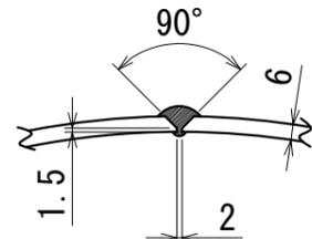
長手継手溶接部詳細図
