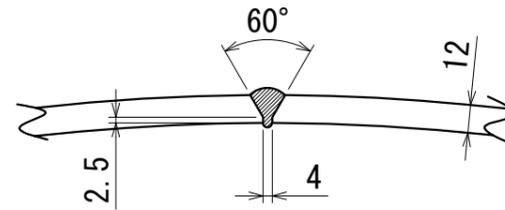
長手継手溶接部詳細図
