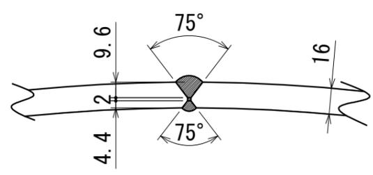
長手継手溶接部詳細図
