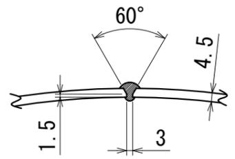
長手継手溶接部詳細図
