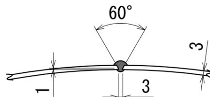
長手継手溶接部詳細図
